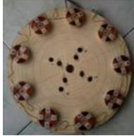
Gambar 5. Desain stator dengan 9 kumparan hubung seri
